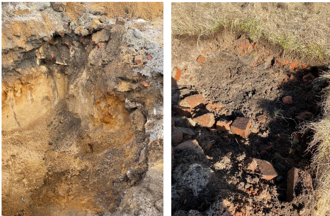
Figur 11. Foton från fältarbete 22-03-16. Till vänster provpunkt 22AF07 och till höger ett delprov i samlingsprovet i provområdet 22AF05 där antropogent material i form av tegel påträffas.
