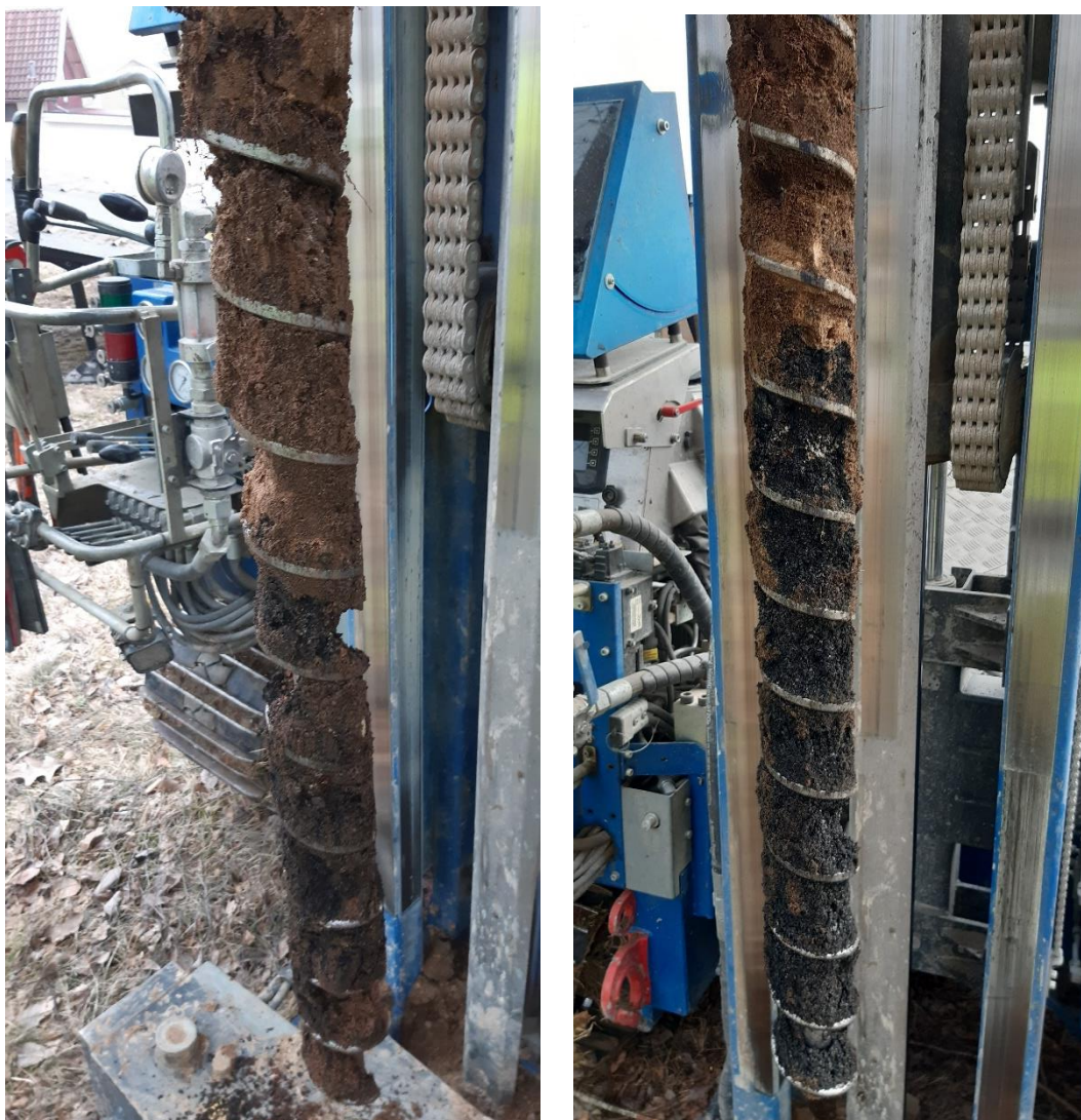
Figur 12. Foton från fältarbete 22-03-16. Till vänster provpunkt 22AF28(0-1m) och till höger provpunkt 22AF29(0-1m). I båda provpunkterna påträffas svart fyllnadsmaterial liknande asfaltskross.
