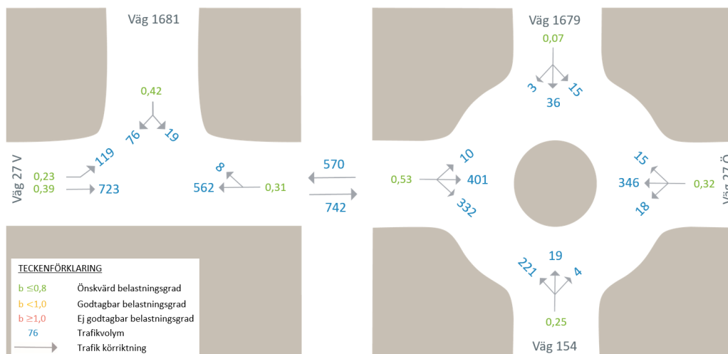
Figur 7. Kapacitetsberäkning för prognosår 2050 - Nollalternativ.
