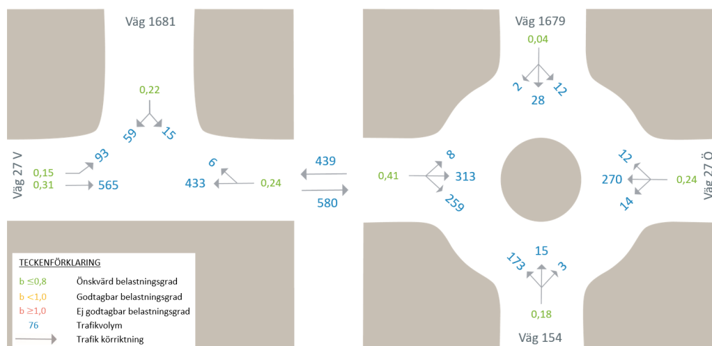
Figur 6. Trafikflöden för nuläge 2022 under eftermiddagens maxtimme samt belastningsgrad i korsningspunkterna väg 27/väg 1681 och väg 27/väg 1679.
