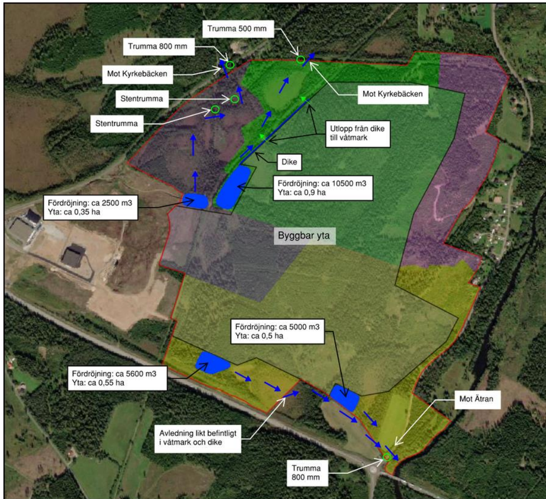
Figur 41. Schematisk dagvattenhantering. Dagvattendammar avsedda för fördröjning och rening redovisade i blått. Avledning från dammarna redovisat med blåa riktningspilar.
