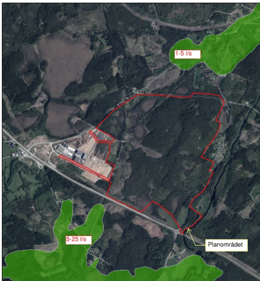
Figur 11. Grundvattenförekomster i närområdet (grön färg) med vattenuttagsmöjligheter (SGU, 2023). Plangränsen som redovisas är från skede innan samråd.
