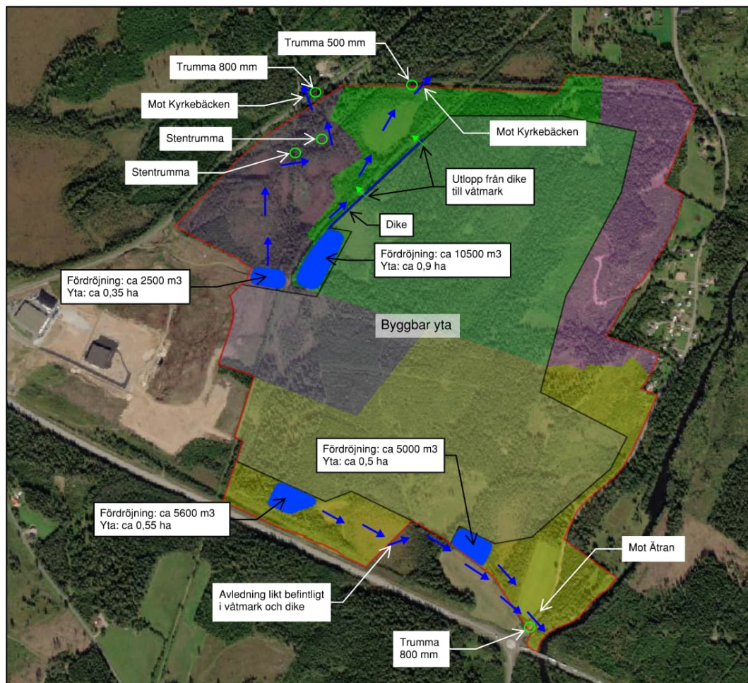
Figur 23. Schematisk dagvattenhantering. Dagvattendammarna avsedda för fördröjning och rening redovisade i blått. Avledning från dammarna redovisat med blåa riktningsspilar.
