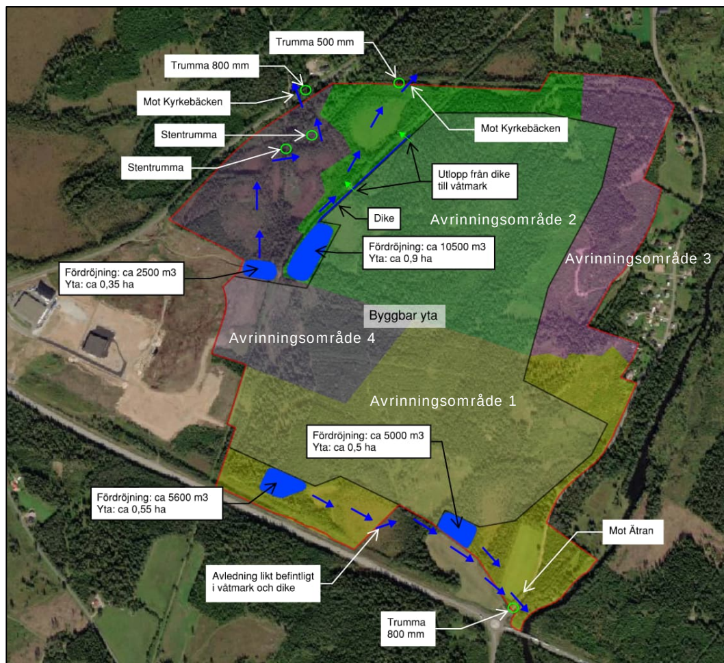
Figur 48. Förslag till placering av fördröjningsanläggningar med erforderlig volym och ytbehov. (AFRY AB, 2024g)
