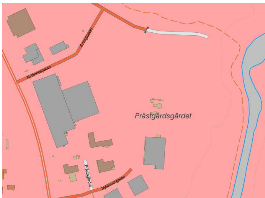
Figur 6. Jordens genomsläpplighet för dagvatten. Rött anger hög genomsläpplighet för markinfiltration. (SGU 2024)
