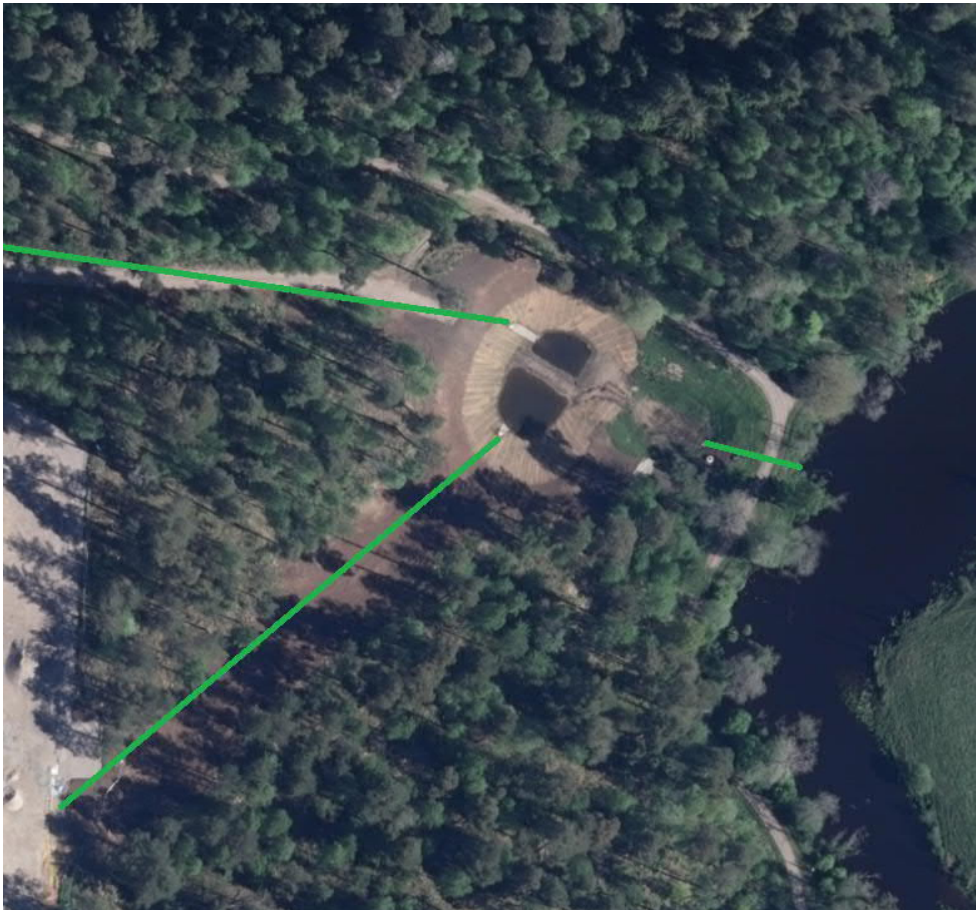
Figur 15. Flygfoto över befintlig dagvattendamm som kommer ta emot dagvattnet från det gröna området. Dagvattenledningar är inritade med grönt. Ledningen längst ner till väster kommer från planområdet. Dagvattendammen är nybyggd vid fototillfället därav den bruna/gula färgen.
