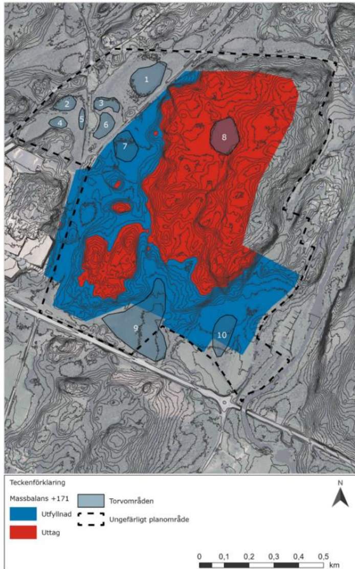
Figur 48 Fördelningen mellan uttag (rött) och utfyllnad (blått) i terrängen vid jämn massbalans, alt.2.
