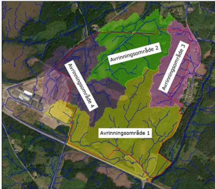
Figur 39. Indelning av planområdet i fyra avrinningsområden baserat på befintlig topografi och utloppspunkter från planområdet.
