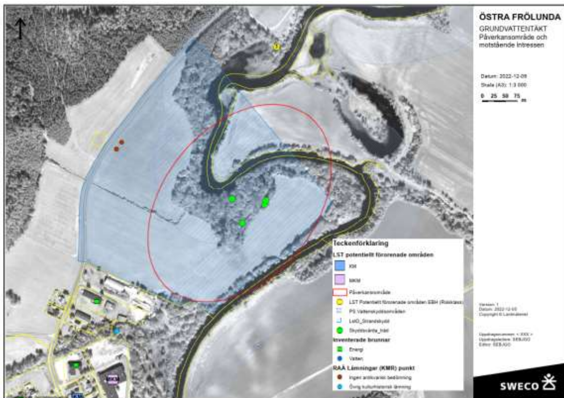
Figur 5. Prognosticerad avsänkning och bedömt påverkansområde för maxuttaget 230 m 3 /dygn, samt inventerade potentiellt motstående instressen.
