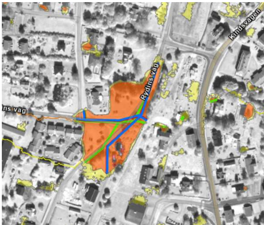
Figur 5. Exempel på identifierad ledningssträcka där det vid ett skyfall samlas vatten ovan ledningarna.
