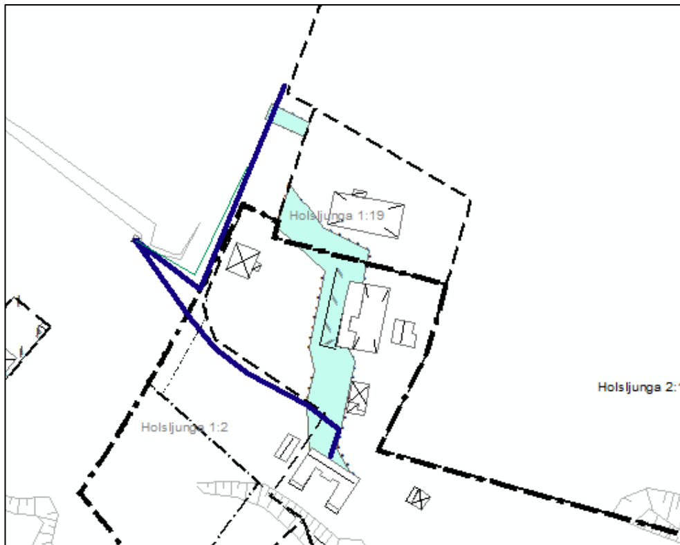
Bild 3: Placering på ledningsrätt för VA-enheten (ljusblå yta) samt för Vattenfalls ledningar (mörkblå linjer). Planområdet syns som svart streckad linje.
