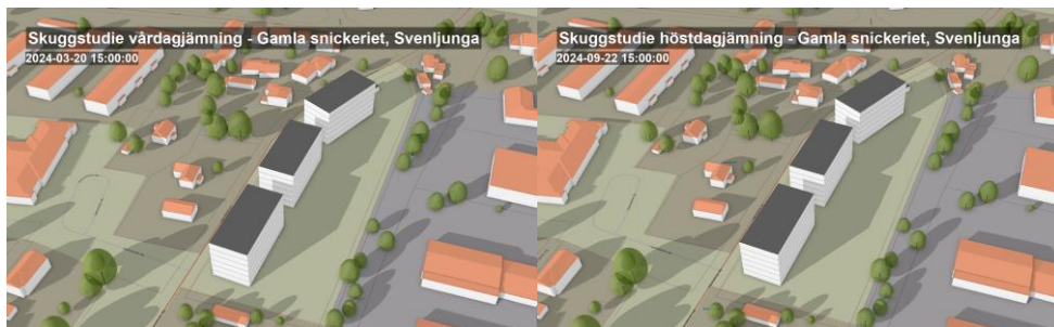
Figur 31 och 32. Sol- och skuggstudier för det södra området kl 15.00 under vårdagjämning till vänster och höstdagjämning till höger.
