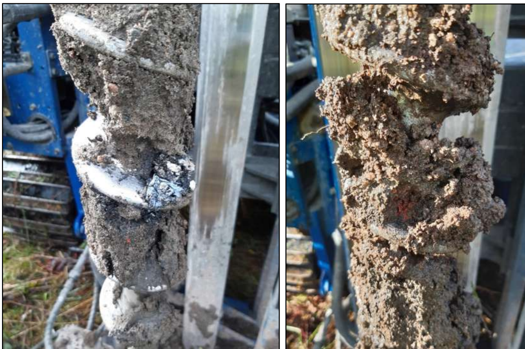
Figur 9. Foton från jordprovtagning 12 oktober 2022. Till vänster punkt 22AF07 (1,5-2 m.u.my.) med inslag av antropogent material i form av plast och gummi. Till höger punkt 22AF08 (ca 0,5 m.u.my.) med inslag av antropogent material i form av tegel.
